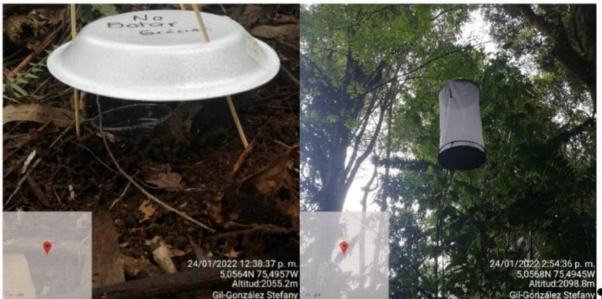
Métodos de colecta. Izq: Trampas pitfall; Der: Trampas Van Someren-Rydon
