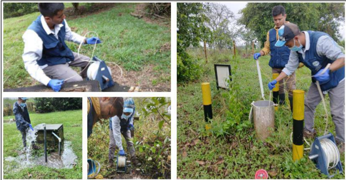
medición de niveles en la primera campaña de monitoreo del acuífero del río Risaralda
