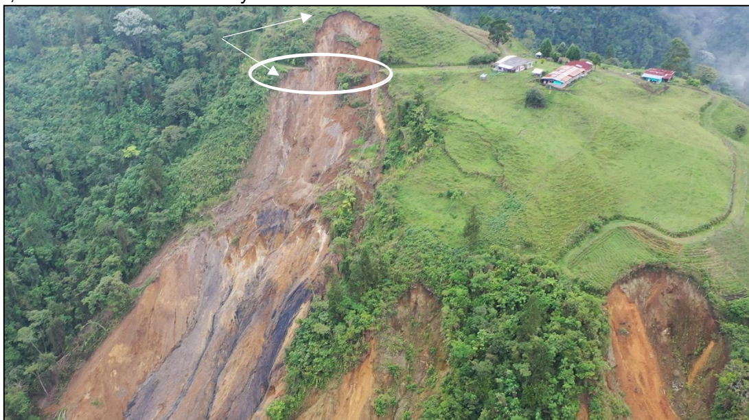
Foto del sobrevuelo sobre el movimiento en el flanco Noroeste de la cárcava, donde se indica el avance del movimiento a principios de marzo, afectando la ladera superior y causando el colapso del carretable o banca de la vía a Santa Rosa
