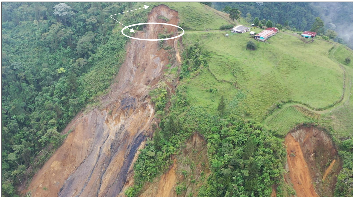
Foto del sobrevuelo sobre el movimiento en el flanco Noroeste de la cárcava, donde se indica el avance del movimiento a principios de marzo, afectando la ladera superior y causando el colapso del carreteable o banca de la vía a Santa Rosa
