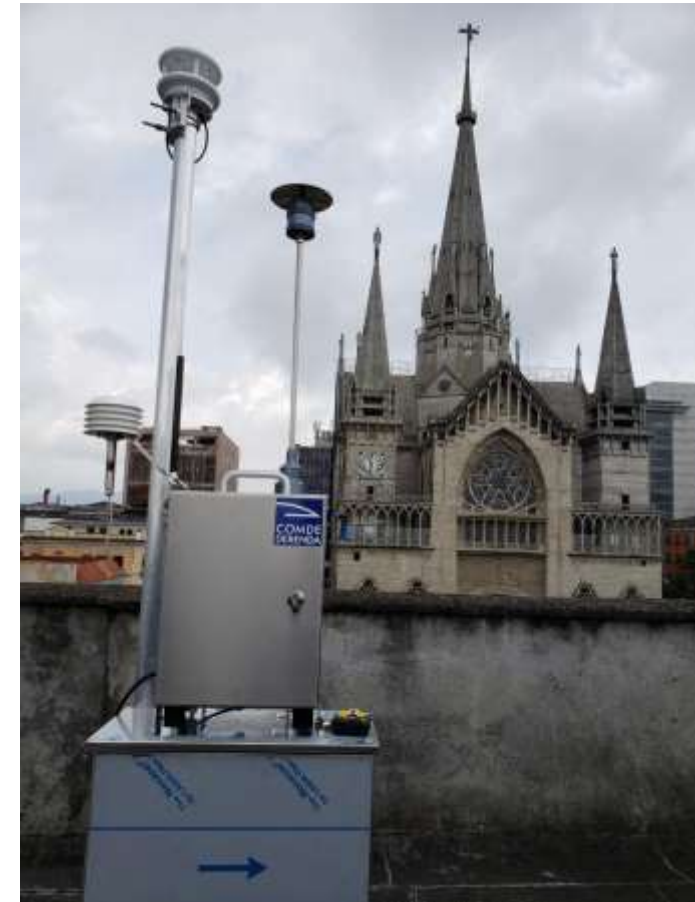
Analizador automático de partículas PM 10 y PM 2.5 , estación Gobernación. Método óptico (nefelómetro)
