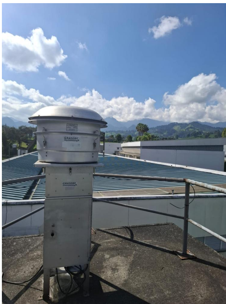
Equipo Hi-Vol Manual / Estación Nubia Campus la Nubia, Universidad Nacional de Colombia / Manizales, Caldas
