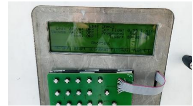
PM 2.5 "Aborted" en chequeo de fugas
