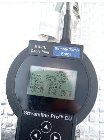
PM 10 y PM 2.5 Error de indicación en flujo
