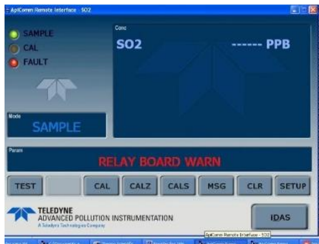
Figura 4. Evidencia de la falla en la tarjeta de electrónica de SO 2 y daños en la bomba de O 3 , entre mayo y junio de 2025
