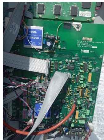
PM 10 Tarjeta board que requiere cambio
