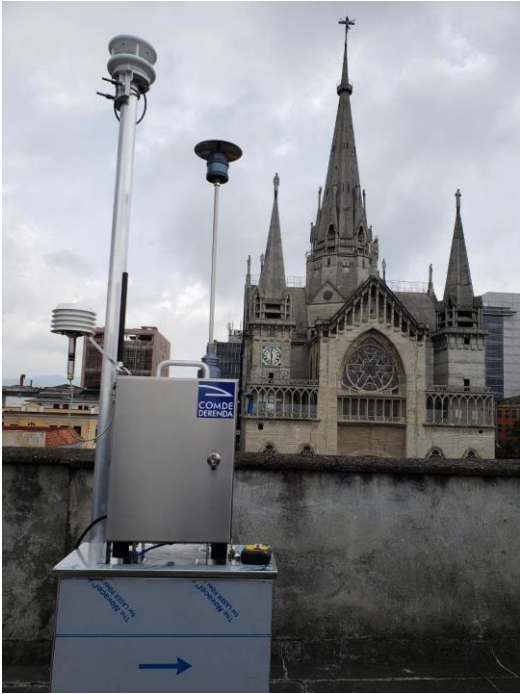
Analizador automático de partículas PM 10 y PM 2.5 , estación Gobernación. Método óptico (nefelómetro)
