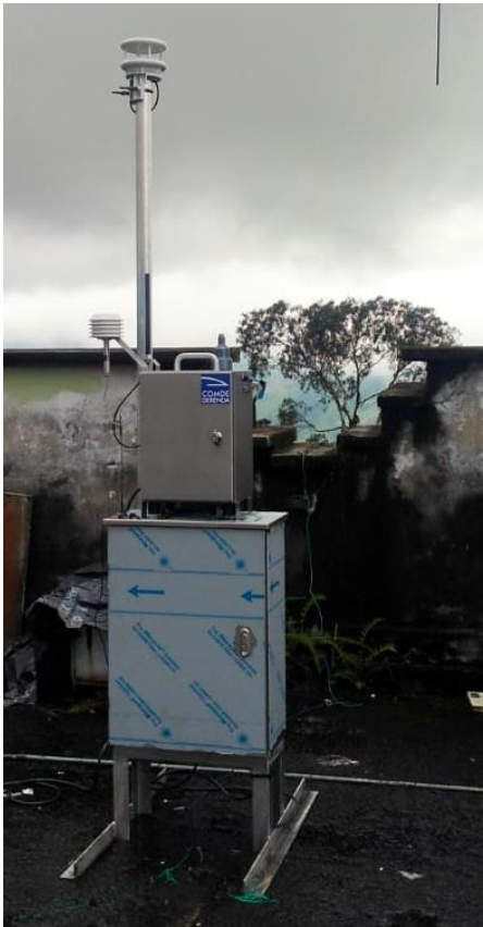
Analizador automático de partículas PM 10 y PM 2.5 , estación Liceo. Método óptico (nefelómetro)
