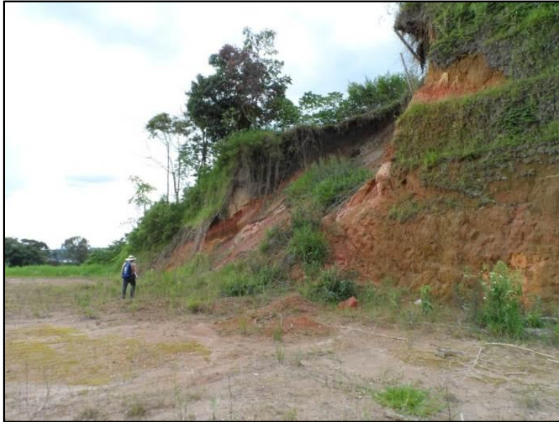
Figura 24.3. Perfil de meteorización de flujos de escombros en el sector de Chinchiná, Caldas. Las interfaces entre dichos suelos y las cenizas volcánicas actúan como nivel de cambio de permeabilidad importante, dando lugar a deslizamientos.
