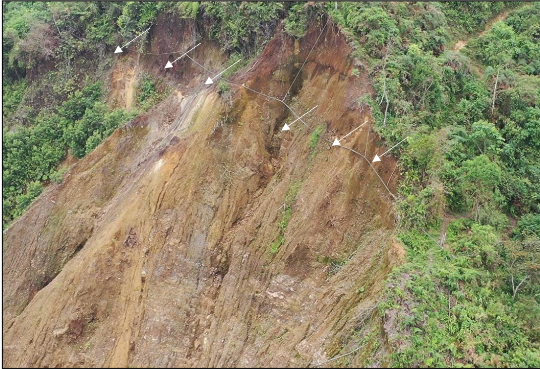
Detalle de la corona del movimiento en la ladera Sur, donde se aprecia el trazado o corrección de la línea de conducción del acueducto, luego de su traslado de la zona media alta del escarpe enunciada en el informe anterior (foto gracias al sobrevuelo con Dron).
