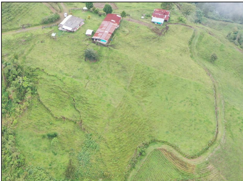
Foto del sobrevuelo sobre la infraestructura del Ecohotel Takuna, donde se aprecia en los terrenos adyacentes inferiores, fracturamientos, fisuras y agrietamientos del terreno, fenómeno de reptación por uso del área como potrero y trazado de una vía interna que no cuenta con adecuado manejo de aguas superficiales
