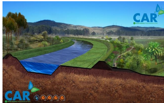
Ilustración 16. Obra para el control de las crecientes, Jarillón río Bogotá.
