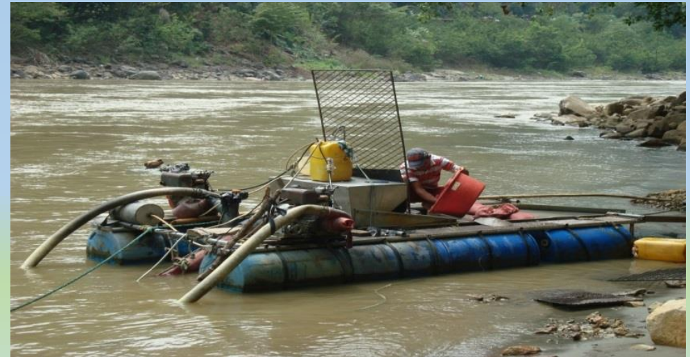
Explotación ilegal de oro aluvial (minidraga) – Aguadas (Elmer HR)
