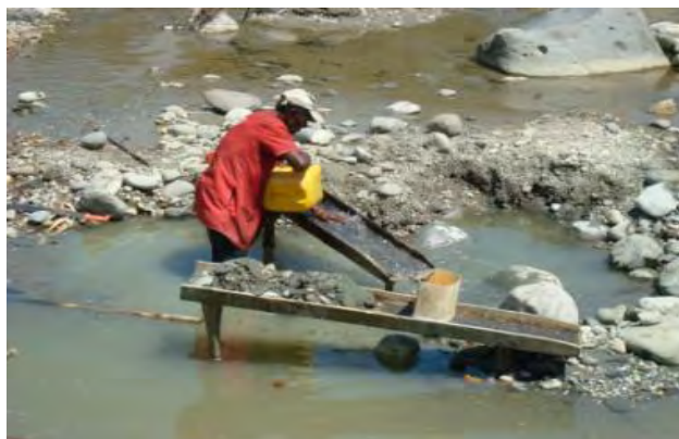
Sistema artesanal de beneficio de oro en La Dorada – Vereda Guarinocito (Elmer H R)
