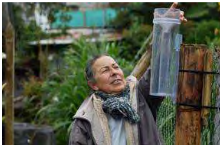
Instalación de pluviómetros (Fuente CIIFEN)
