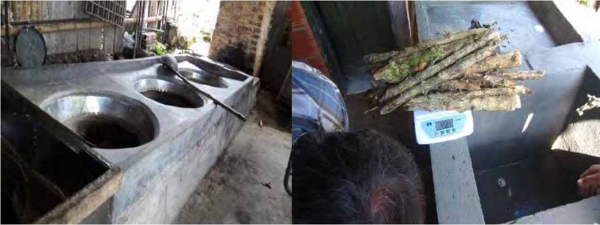
Horno ecoeficiente en Pensilvania, y medición de leña estufas en Chinchiná. Fuente: FUMSOL y Cerro Bravo, fundaciones contratistas de Corpocaldas.
