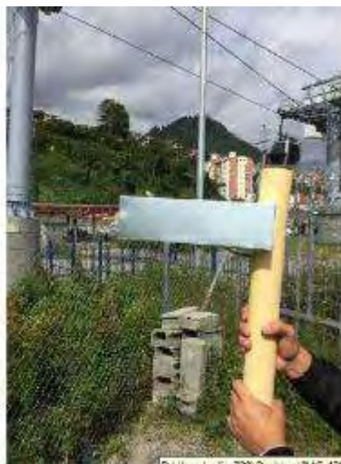
Montaje de estaciones con muestreadores pasivos, para la determinación de benceno, tolueno y xileno (BTX) en el aire en Manizales, 2018.
