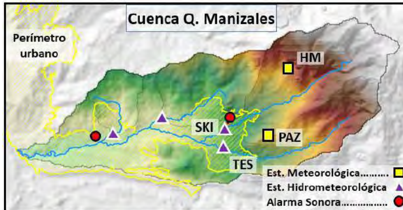
Distribución de la red de monitoreo SAT para la cuenca quebrada Manizales
