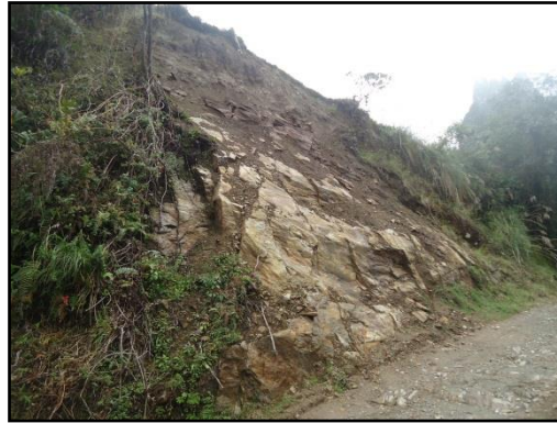
Figura 35. Afloramiento del Intrusivo Néisico de Manizales o Milonita Granítica del Guacaica, sector La Gruta. Fuente: Propia.
