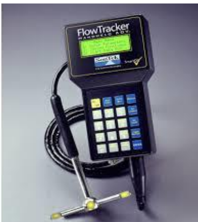
Equipo automático de medición de caudales
