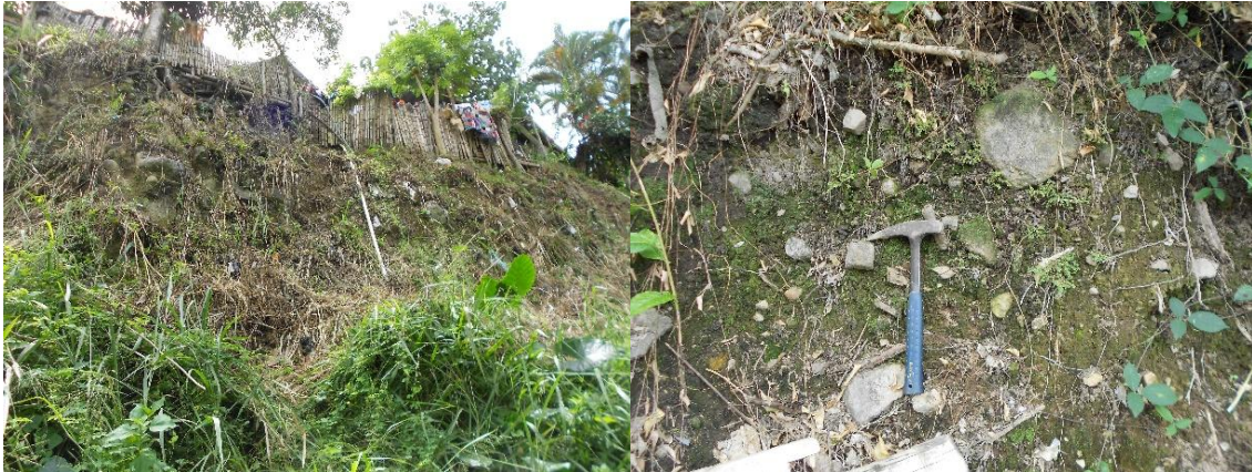
Figura 27.18. Flujos de Escombros del Kilómetro 41 en el talud derecho de la carrilera (Izq.), y detalle de los fragmentos y matriz del flujo de escombros superior en cercanías al puente sobre el Río Cauca (Der).
