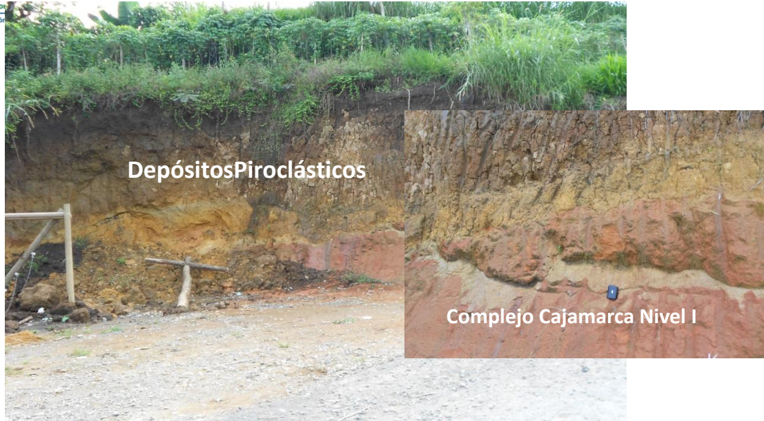
Figura 1.4. Perfil Geológico del Corregimiento de Santa Elena, El basamento de color rojo corresponde a las rocas metamórficas del Complejo Cajamarca y definen el nivel I de meteorización, y están suprayacidos por depósitos piroclásticos, se observa la disposición general del afloramiento con una orientación N-S, y una foto de detalle del contacto entre el basamento y la cubierta de los depósitos piroclásticos, el tamaño del sobre de la cámara es 12 cm.
