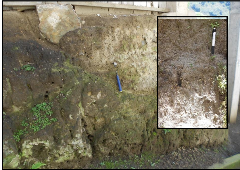
Figura 1.5. Nivel Café de depósitos de flujos piroclásticos en el sector central del corregimiento, a la derecha detalle de la textura y el tamaño de grano de los depósitos, por debajo del lapicero se observa un nivel de pómez con tamaño lapilli.
