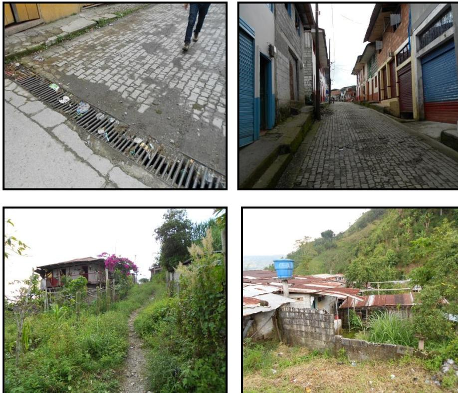
**Figura 1.34.** **Arriba:** Sector central del corregimiento con manejo adecuado de las aguas de escorrentía con sumideros. **Abajo:** sector oriental en la salida hacia Samaná, varían drásticamente las condiciones de manejo de aguas en los accesos a las viviendas y en las viviendas mismas.
