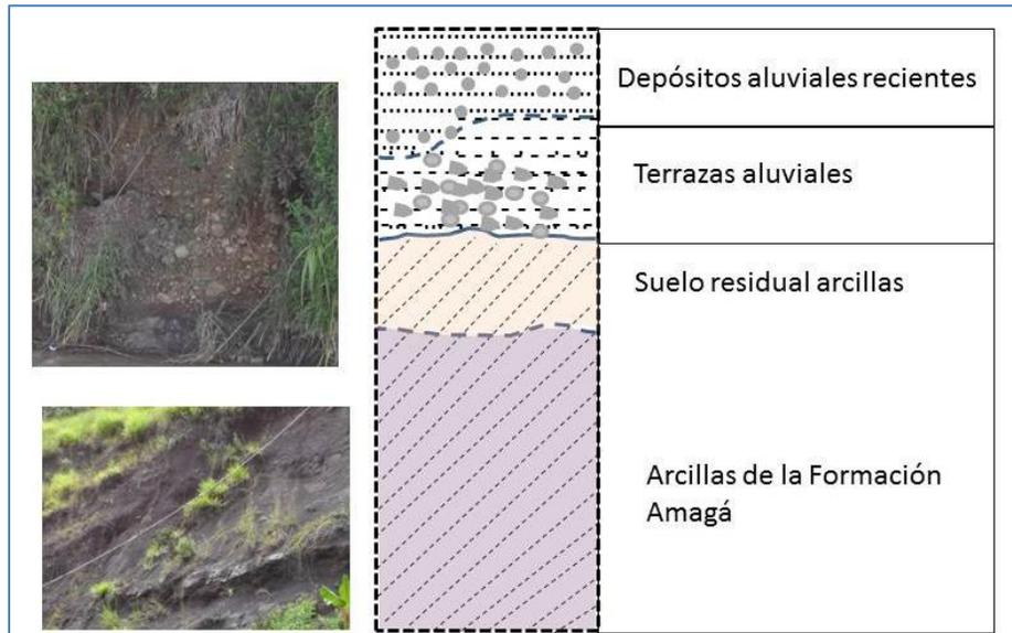
**Figura 22.1.** Perfil esquemático de unidades geológicas aflorantes en el sector de Supía, Caldas.
