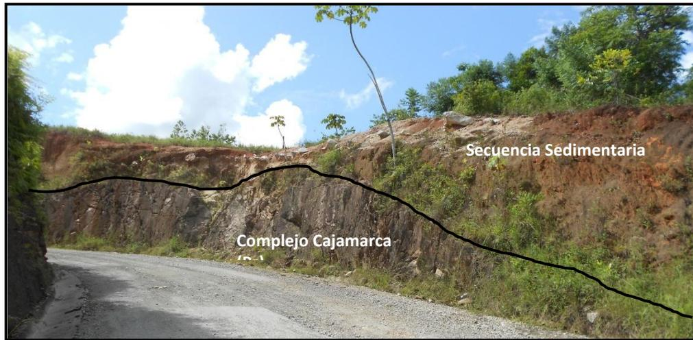
**Figura 1.12.** Perfil Geológico del Corregimiento de Isaza, fotografía tomada en el talud Norte de la variante, localizada al Norte del corregimiento, ver Figura 1. Complejo Cajamarca (Pz) suprayacido discordantemente por la secuencia sedimentaria de color rojizo. Dirección de la fotografía: N310°.
