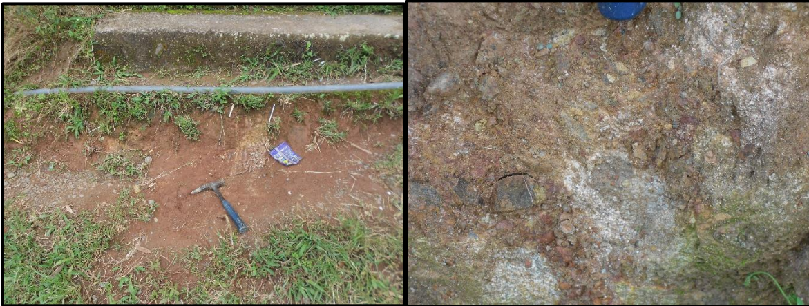
Figura 20.28. Niveles I ( Izquierda ) y II ( Derecha ) de Meteorización de los gabros del Stock de Chinchiná-Santa Rosa (alto de la fotografía: 0,6 m).
