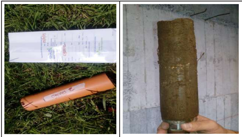
Figura 10. Toma de muestras de suelo para medir la densidad aparente.
